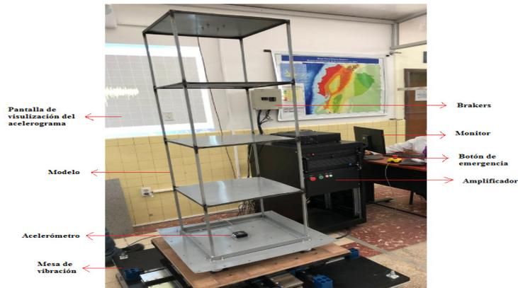
**Figura 6.** Componentes de la mesa de vibración
