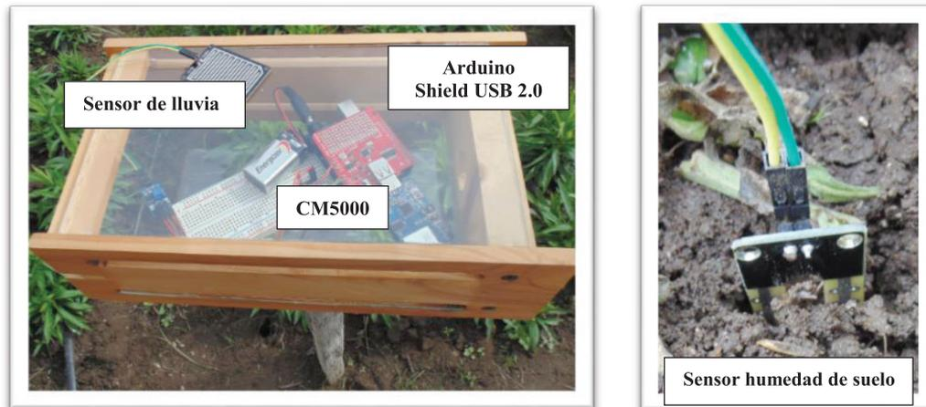
Figura 1. Elementos de hardware de la inalámbrica propuesta.
