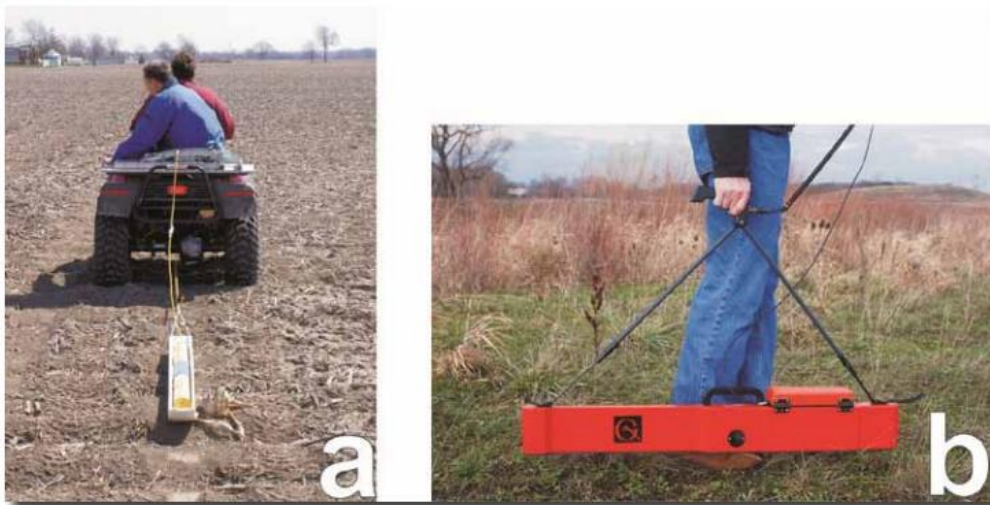
Figura 2. Ejemplos de medidores de conductividad del suelo utilizados en entornos de agroecosistemas; (a) DUALEM-1S, y (b) EM38-MK2 (Tomado de Allred & Freeland, 2010).
