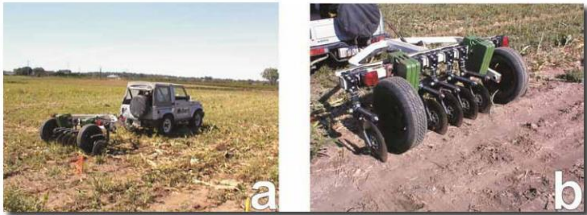
Figura 1. Ejemplo de un sistema de resistividad de contacto galvánico de medición continua. (a) Sistema de cartografía Veris 3100 Soil EC y (b) acercamiento de los enrejadores de acero utilizados para electrodos actuales y potenciales por el Veris 3100 Soil EC Mapping System (Tomado de Allred & Freeland, 2010).
