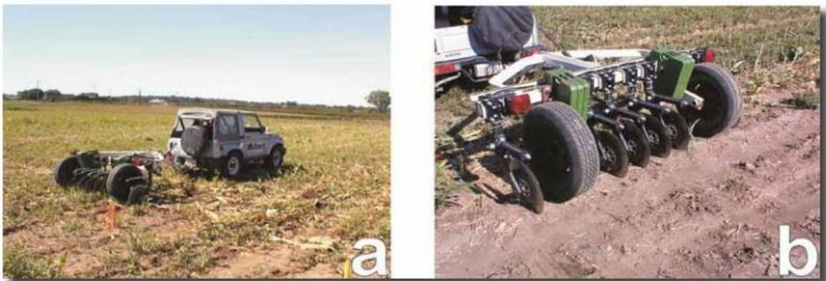
**Figura 1.** Ejemplo de un sistema de resistividad de contacto galvánico de medición continua. (a) Sistema de cartografía Veris 3100 Soil EC y (b) acercamiento de los enrejadores de acero utilizados para electrodos actuales y potenciales por el Veris 3100 Soil EC Mapping System (Tomado de Allred & Freeland, 2010).
