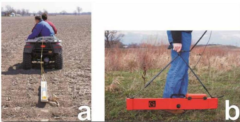
**Figura 2.** Ejemplos de medidores de conductividad del suelo utilizados en entornos de agroecosistemas; (a) DUALEM-1S, y (b) EM38-MK2 (Tomado de Allred & Freeland, 2010).
